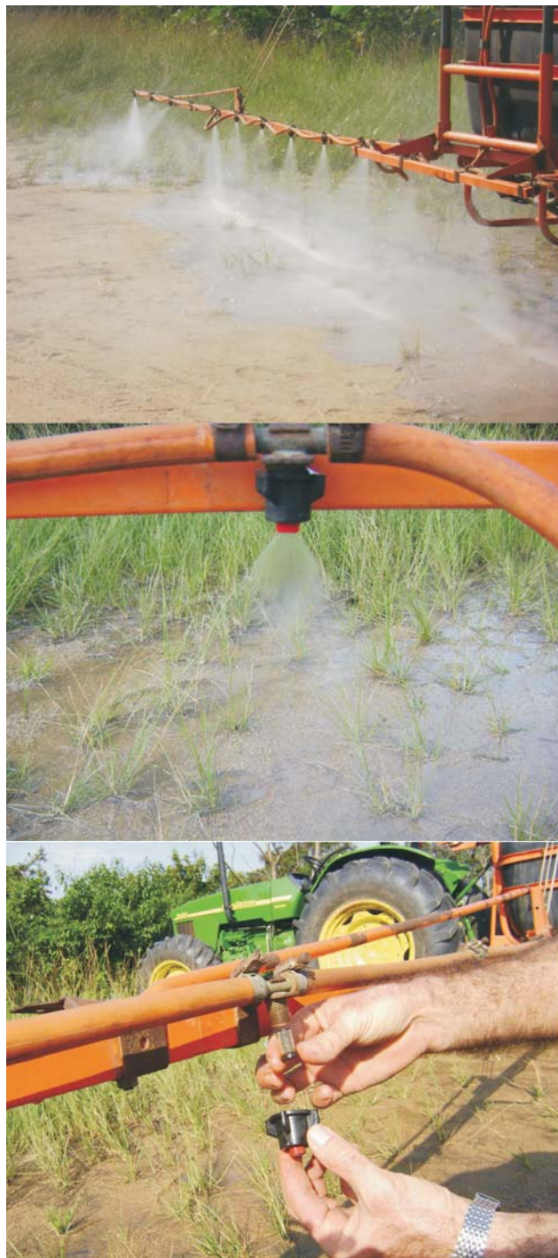
Figura 6. Avaliação periódica e manutenção dos equipamentos de aplicação de agrotóxicos para o controle da mosca-branca em hortaliças.
